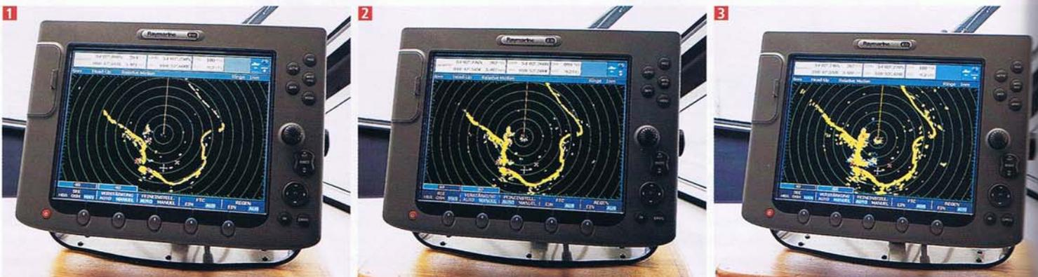
Je nach Verstärkungsregelung (Gain) sind Ziele im Umkreis gut zu erkennen (Bilder 1 und 2). Wenn die Verstärkung zu sensibel eingestellt, also hochgeregelt wird, verschwinden die deutlichen Echos langsam (Bild 3). Ab einer Einstellung von 80 sind im näheren
